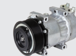
揺動板式固定容量コンプレッサー (SDシリーズ)
