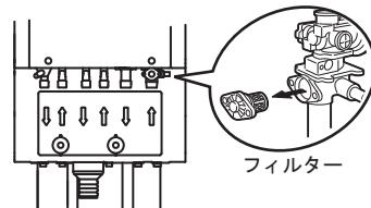
(2) ヒートポンプ配管のフィルター部のゴミづまりを点検する。
