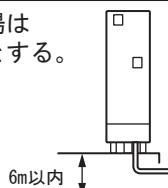
負圧によりタンクが破裂したり、空気の混じった湯水が飛び散りやけど・水漏れの原因になります。
