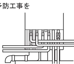
凍結すると、本体が破損したり、配管が破裂してやけどをすることがあります。
