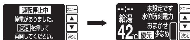
・停電表示になりますので、決定を押すと、左の画面を表示します。（台所リモコンの場合）
