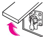
沸き上げ時、タンク内の圧力上昇を防ぎます。
