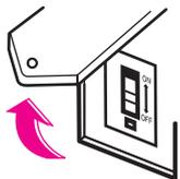
漏電したときに電気の流れを自動的にしゃ断します。
