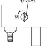
⑤貯湯タンクユニットの水抜き栓8カ所を開く。
