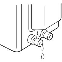
全部ゆるめると、水抜き栓が抜けてしまいますので、気をつけてください。
