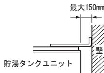
②M10アンカーボルトで壁面に固定します。
