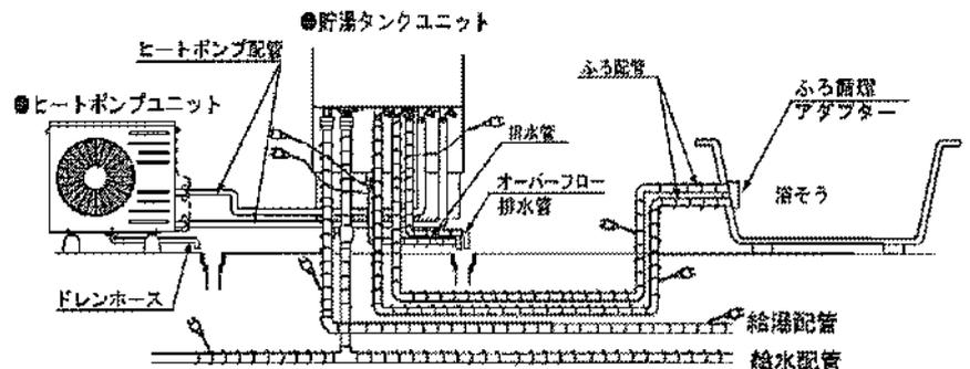
給水配管、給湯配管、ふろ配管、タンク排水管、オーバーフロー排水管にヒーターを均一に巻いてください。
