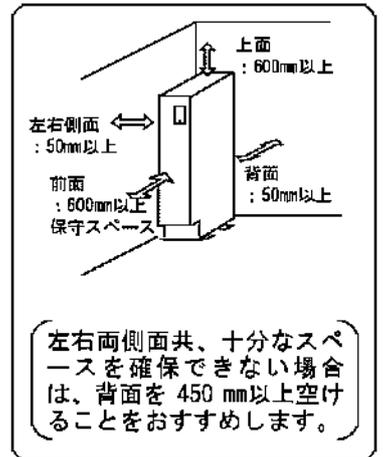
ヒートポンプユニットと貯湯タンクユニット間の据付制約
