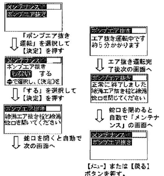
※給湯循環ポンプのエア抜きが異常な場合、右図の画面が表示されます。
