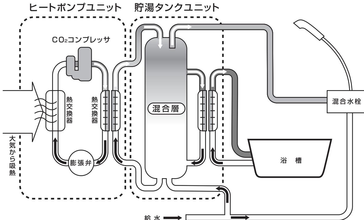
自然冷媒ヒートポンプ給湯機とは、ヒートポンプユニット内に封入された冷媒（CO<sub>2</sub>）の働きを利用し、熱交換器で大気の熱を集め、お湯を沸かし、タンクユニットに貯湯し利用するシステムです。そのためタンク満たんまでの沸き上げに時間を要します。
