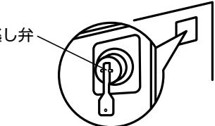
点検しないとタンクや配管が破損したり、逃し弁から水漏れしたりすることがあります。
