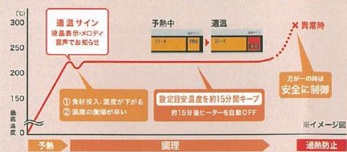
適温調理（「ステーキ」メニュー）で調理した場合の流れ（当社試験データ）
