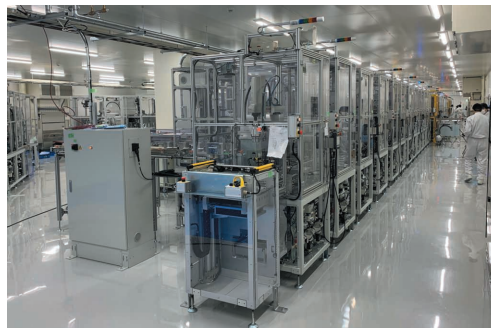
八斗島事業所の組み立て自動化ライン
